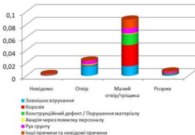
Рис.1. Первинна частота пошкоджень, причина та розмір витіку ([13])
