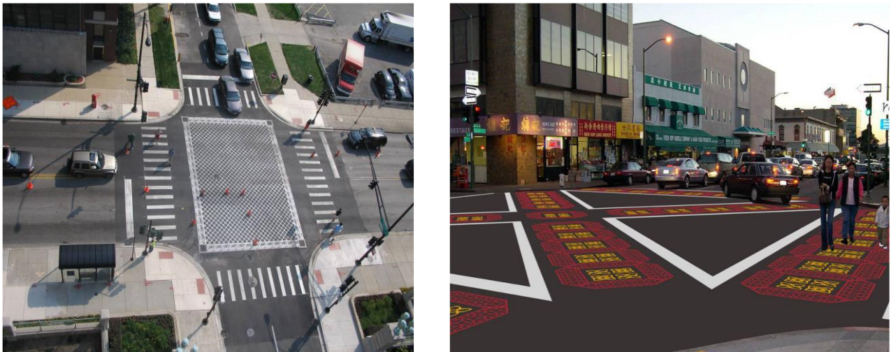
Рис. 3. Приклади багатокольорової розмітки перехресть і пішохідного переходу
