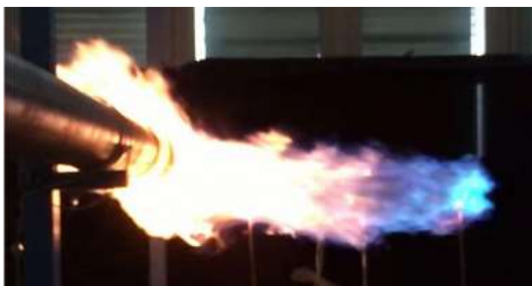
Рис.3. Видиме зображення пропанового струменевого вогню, що впливає на трубу ( d = 0,5 см; D_{тр} = 0,11 м).
